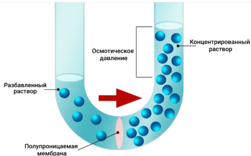
Рис. 3. Осмос через полупроницаемую мембрану - вода движется из разбавленного раствора в концентрированный
