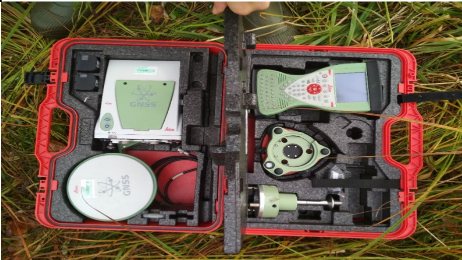
Съемка с помощью роверного GPS-приемника
