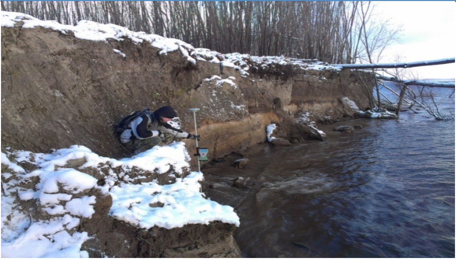
Съемка с помощью роверного GPS-приемника
