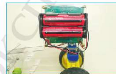
Рис. 16.10. Сборка робота. Шаг 7. Аккумуляторы
